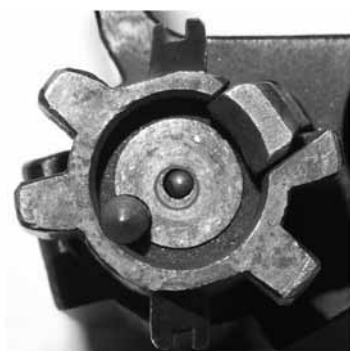
Передний срез затвора
