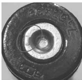
Донная часть гильзы, стреляной из карабина ОП СКС
