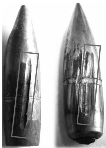
Рис. 4. Следы от штифта, установленного в канале ствола, на: а) пуле, выстреленной из карабина охотничьего «СВТ-О», изготавливаемого на базе автоматической винтовки Токарева образца 1940 года («АВТ-40»); б) пуле, выстреленной из карабина охотничьего «КО-СВТ», изготавливаемого на базе самозарядной винтовки Токарева образца 1940-х годов («СВТ-40»)
